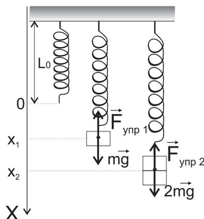
Подвесим на пружину груз массой  $m$ . Пружина деформируется и указатель перемещается в точку с координатой  $x_1$ . Тогда величина абсолютной деформации будет определяться текущей координатой курсора.
