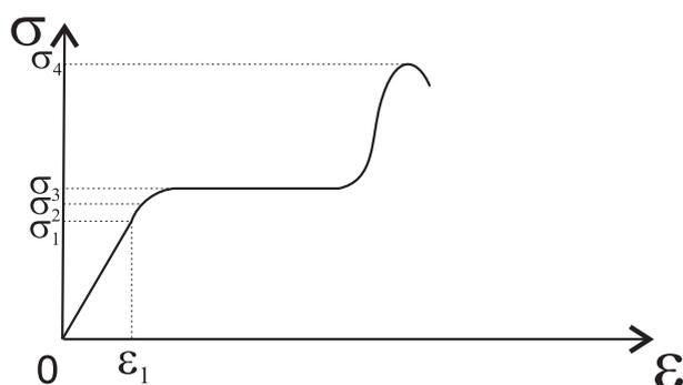
При малых деформациях  $\epsilon < \epsilon_1$  будет выполняться закон Гука, т.е. пропорциональная зависимость  $\sigma \sim \epsilon$ , соответственно  $\sigma_1$  принято называть пределом пропорциональности.
