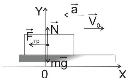
Сделаем рисунок. На санки действует сила трения, сила тяжести и нормальной реакции опоры. Скорость направлена вправо, а ускорение влево.
