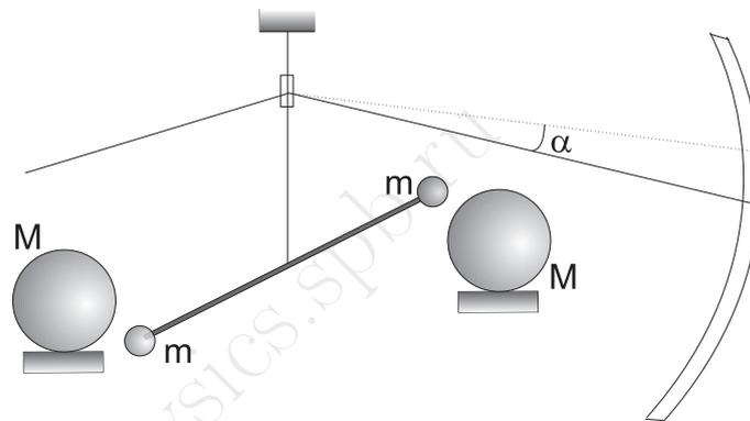
Под действием сил притяжения малых шаров к большим, коромысло немного поворачивалось, и по закручиванию подвеса измерялась сила.
