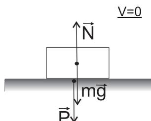
Вследствие притяжения к Земле, тело давит на поверхность с силой называемой весом тела, в результате чего поверхность реагирует с силой нормальной реакции опоры. Вес тела и сила нормальной реакции равны по величине и противоположены по направлению, вследствие III закона Ньютона. Эти две силы являются результатом взаимодействия тела и поверхности.
