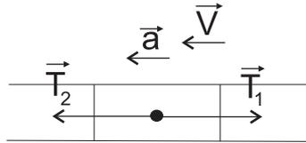
Выделим произвольный участок нити массой  $\Delta m$ . На него действуют две силы  $\vec{T}'_1$  и  $\vec{T}'_2$ . Запишем второй закон Ньютона:
