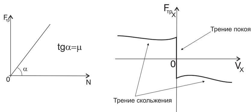
График  $F(N)$ : Тангенс угла наклона графика зависимости силы трения от силы нормальной реакции опоры численно равен коэффициенту трения
