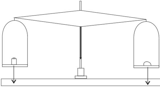
Равноплечный рычаг оказывается в равновесии, если на оба его конца действуют одинаковые силы.
